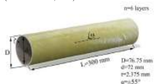
Fig. 1. Geometry of GFRP pipes (Kara and Kırıcı, 2017)
