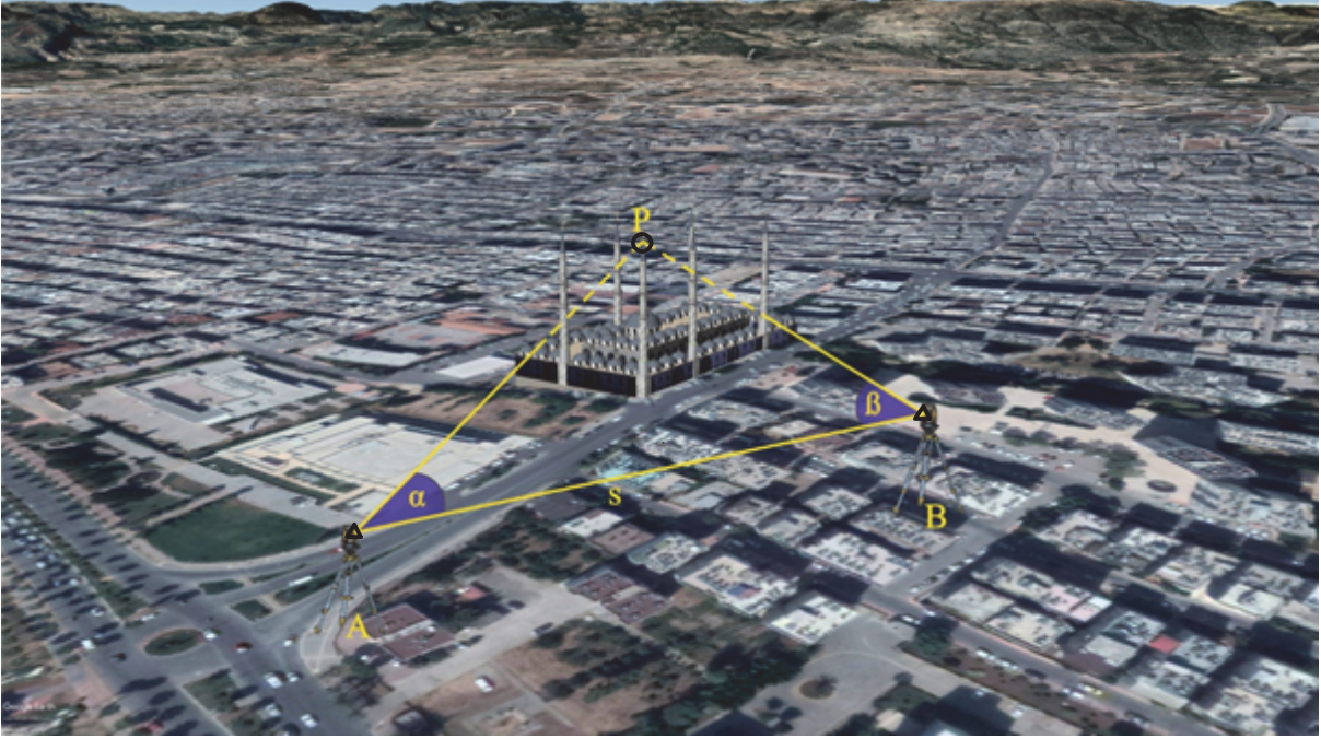
Şekil 1.1. P noktasının ileriden kestirme açı ölçüsü
