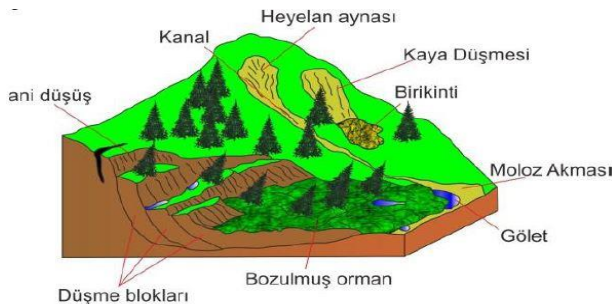
Şekil 2. Heyelanı oluşturan temel elemanlar (Zeybek & Şanlıoğlu, 2013; Varnes, 1978)
