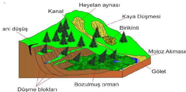
Şekil 2. Heyelanı oluşturan temel elemanlar (Zeybek & Şanlıoğlu, 2013; Varnes, 1978)
